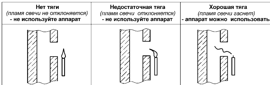
Рисунок 7. Способ проверки тяги в дымоходе
