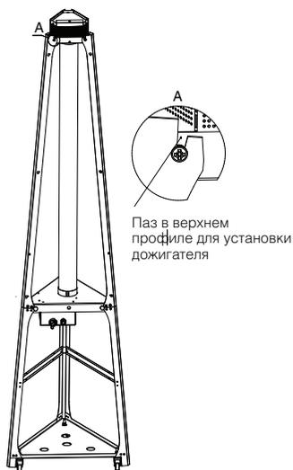
Рис. 3 – Установка колбы и дожига
