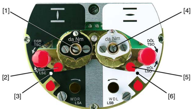
рис. 22: Регулировочные элементы концевого выключателя
