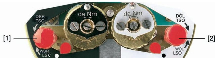
1. Ручку [1] повернуть в направлении стрелки МВЗ: срабатывает моментный выключатель направления ЗАКРЫТЬ.
