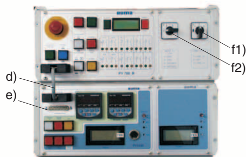
Рисунок 5д Вид спереди PV 788 В (специальное исполнение с выбором напряжения питания) Измерительный модуль (опция- 1000 Нм)
