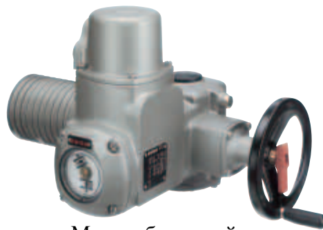
Многооборотный привод SA 07.1 – SA 16.1 / SA 25.1 – SA 48.1 крутящий момент от 10 до 32000 Нм Число оборотов от 4 до 180 в мин.
