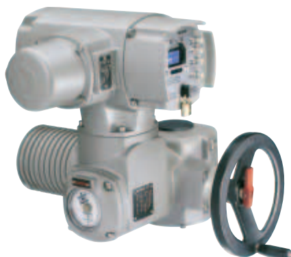
Многооборотный привод SA/ SAR с блоком управления AUMATIC крутящий момент от 10 до 1000 Нм число оборотов от 4 до 180 в мин.
