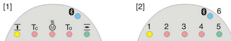
рис. 54: Расположение ламп и описание ламповой индикации
