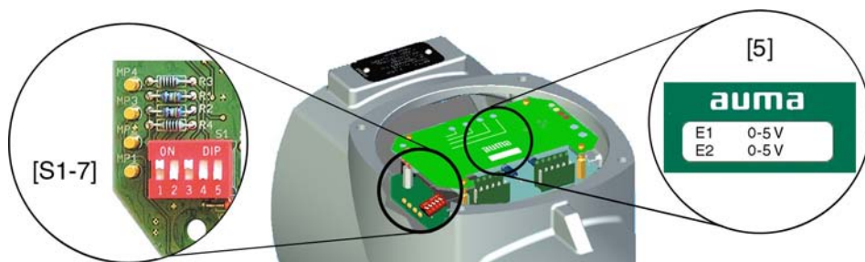
рис. 34: Исполнение с дополнительным переключателем на плате позиционера
