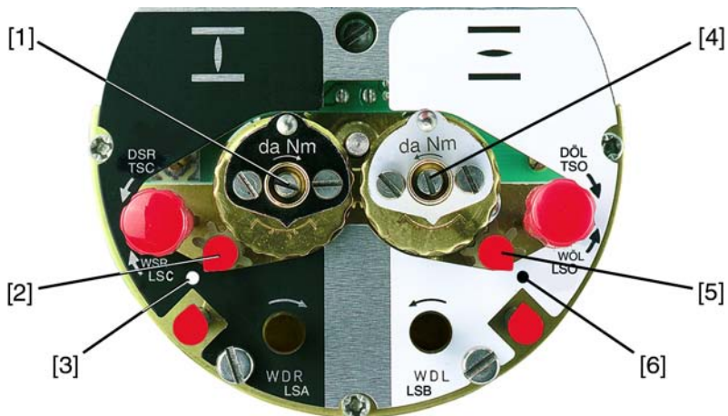
рис. 26: Регулировочные элементы концевого выключателя
