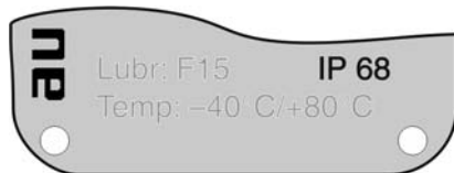
рис. 11: Пример: Согласно заводской табличке - степень защиты IP68
