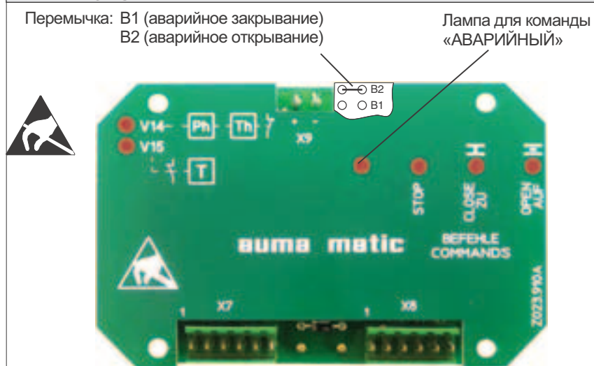
Рис. 46: защитная пластина в режимах АВАРИЙНОЕ ОТКРЫВАНИЕ и АВАРИЙНОЕ-ЗАКРЫВАНИЕ
