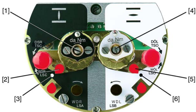
рис. 67: Регулировочные элементы концевого выключателя
