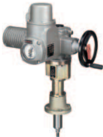
Прямоходный механизм LE с электроприводом SA усилие на штоке от 4 кН до 217 кН величина хода до 500 мм скорость перемещения от 20 до 360 мм/мин.
