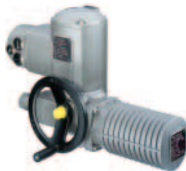
Неполноповоротные электроприводы SG 05.1 – SG 12.1 крутящий момент от 100 до 1 200 Нм время поворота на 90° от 4 до 180 сек.
