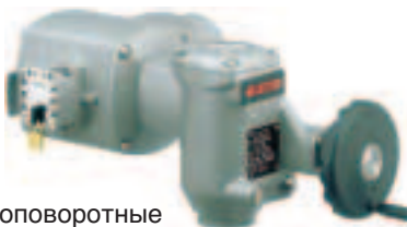
Неполноповоротные электроприводы SG 05.1 – SG 12.1 крутящий момент от 100 до 1 200 Нм время поворота на 90° от 4 до 180 сек.
