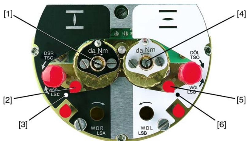
рис. 68: Регулировочные элементы концевого выключателя
