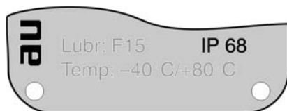
рис. 11: Пример: Согласно заводской табличке - степень защиты IP 68
