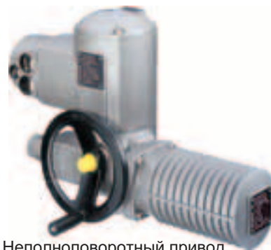
Неполноповоротный привод SG 05.1 – SG 12.1 крутящий момент от 100 до 1200 Нм время позиционирования дл 90° от 4 до 180 сек.
