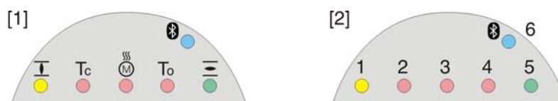
рис. 64: Расположение ламп и описание ламповой индикации
