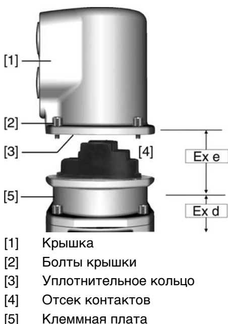
рис. 14: Взрывозащищенный штекерный разъем КРН
