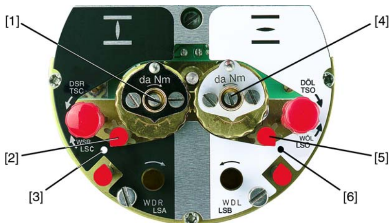
рис. 60: Регулировочные элементы концевого выключателя
