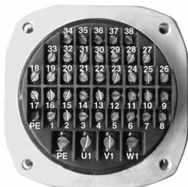
рис. G3: EEx e-присоединительные зажимы на клеммной колодке
