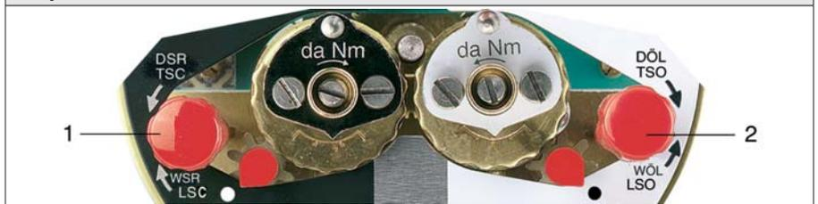
Контрольные ручки (1) и (2) предназначены для ручного управления выключателями.
