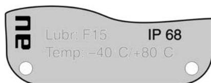
рис. 13: Пример: Согласно заводской табличке - степень защиты IP68
