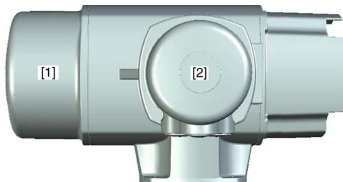
рис. 60: Доступ к предохранителям
