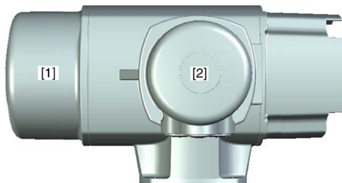
рис. 64: Доступ к предохранителям
