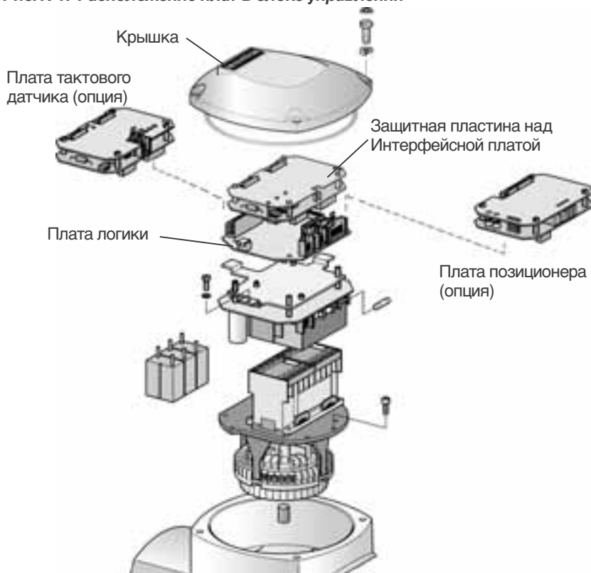
Рис. R-1: Расположение плат в блоке управления
