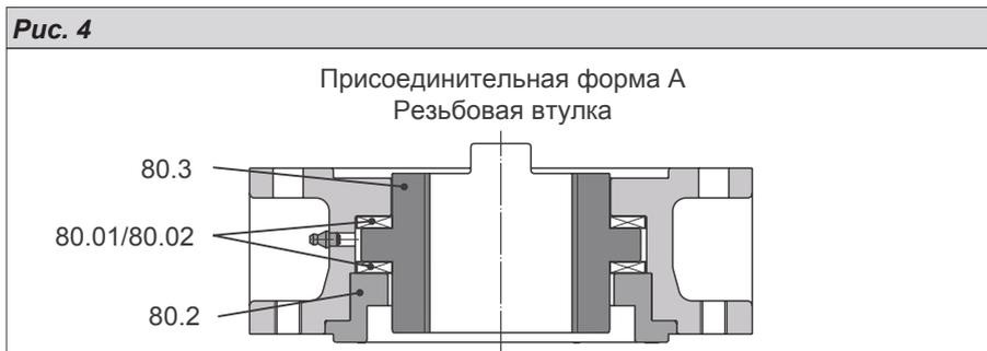
Фланец выходного элемента не нужно отсоединять от привода.
