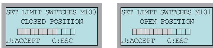
Теперь привод можно привести в новую позицию для выбранного конечного положения. Эта операция выполняется либо вручную с помощью маховика, либо от электродвигателя.
