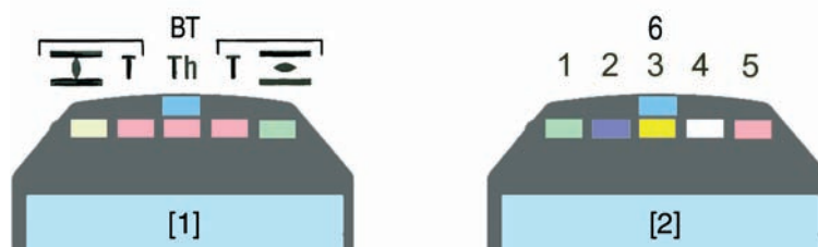
рис. 35: Сигнальные лампы панели местного управления
