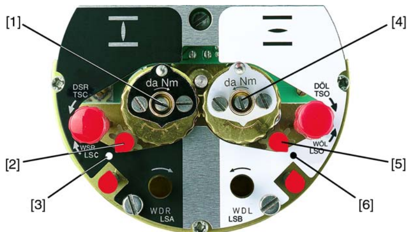
рис. 27: Регулировочные элементы концевого выключателя
