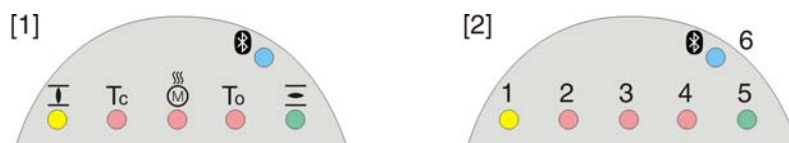
рис. 56: Расположение ламп и описание ламповой индикации
