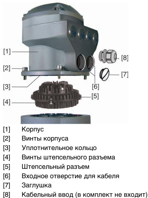
рис. 13: Сетевой штепсельный разъем AUMA SD-шины
