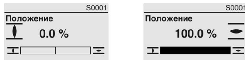
рис. 47: Достигнуто конечное положение ОТКРЫТО/ЗАКРЫТО
