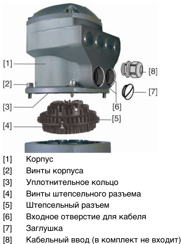
рис. 13: Сетевой штепсельный разъем AUMA SD-шины
