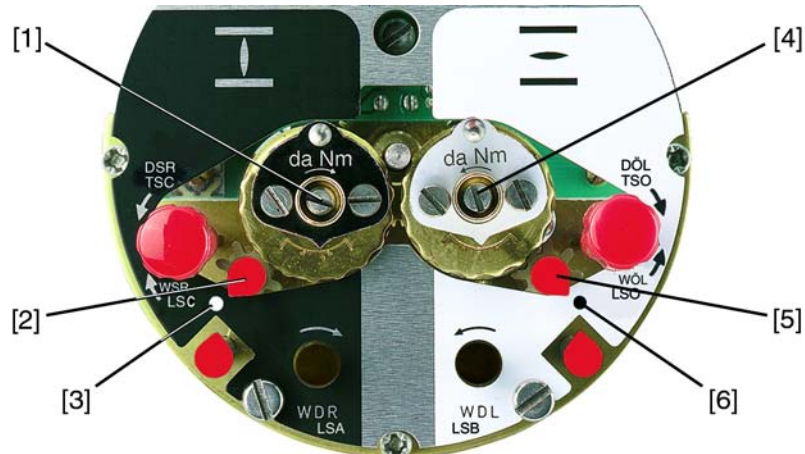
рис. 68: Регулировочные элементы концевого выключателя
