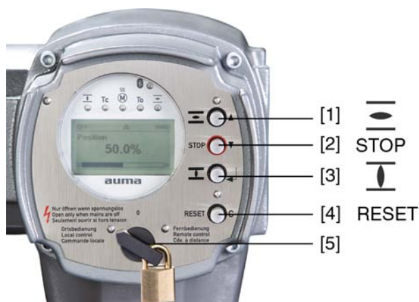
рис. 27: Панель местного управления
