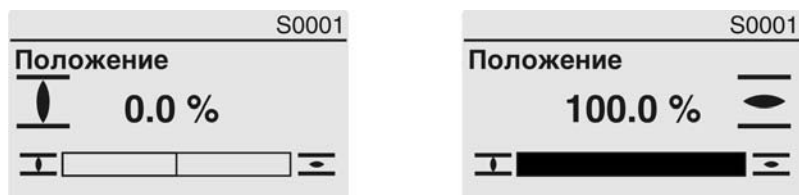
рис. 47: Достигнуто конечное положение ОТКРЫТО/ЗАКРЫТО
