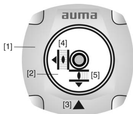
рис. 36: Механический указатель положения
