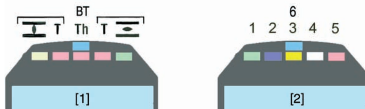
рис. 35: Сигнальные лампы панели местного управления
