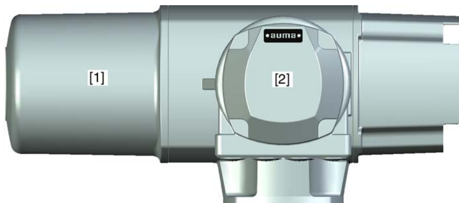
рис. 55: Доступ к предохранителям
