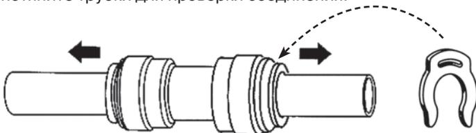
Для предотвращения случайного разъединения зафиксируйте кольцо скобой.
