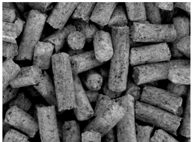
Рис. 18 – некачественные древесные пеллеты – темные, с примесью коры (с черными вкраплениями)
