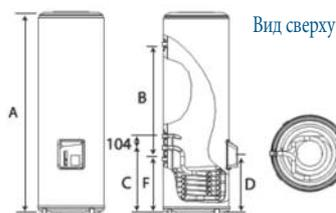
A: Для определения высоты на треножнике, прибавить 490 мм
