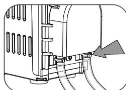
Fixer le tuyau sur les tuyauteries d'admission et de refoulement de la pompe avec des serre-câbles.
