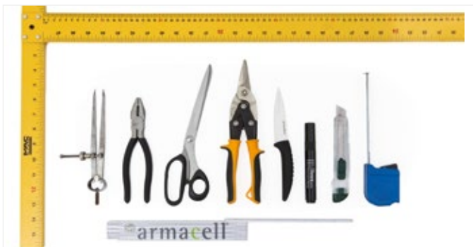
Рисунок 5. Рекомендованные инструменты для установки ArmaGel HT.
