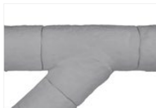
Рисунок 53. Установите кусок для наклонного ответвления и затяните его проволокой, убедившись, что все соединения герметичны и не имеют зазоров.
