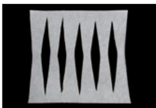
Рисунок 38. Вырежьте ромбовидные куски для чередующихся сегментов из листа ArmaGel HT.
