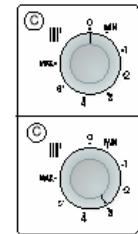
В летнем режиме котел работает только на приготовление горячей воды. Выбор режима работы осуществляется ручкой «**C**» панели управления котла. Установив ручку «**C**» в положение «**0**», вы выбираете летний режим работы котла. Зимний режим выбирается при установке ручки «**C**» в любое промежуточное положение между отметками «**min**» и «**max**»
