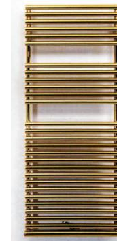
**BW** состоит из горизонтальных стальных труб (Ш25 x 1,25 мм), расположенных параллельно друг к другу и соединенных при помощи закрытой прессовой сварки с собирающими вертикальными трубками (Ш26 x 1,55 мм). Между горизонтальными
