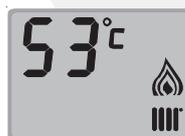
Если на дисплее отображается символ
