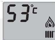
Во время работы в режиме отопления, на дисплее отображается температура воды и символ (🔥) постоянно включен.
