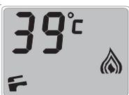
Во время всего процесса забора воды на дисплее отображается температура горячей воды и горит символ (🔥).
