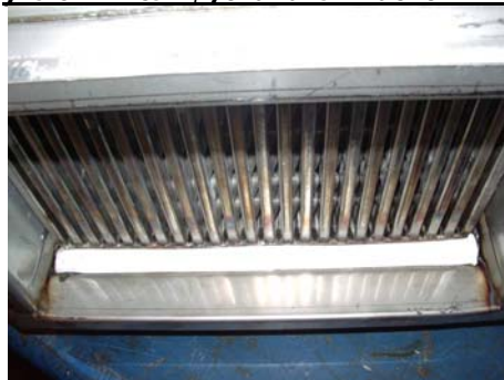
Рисунок 17 б: трехгранный PTFE уплотнитель, устанавливается в желоб
