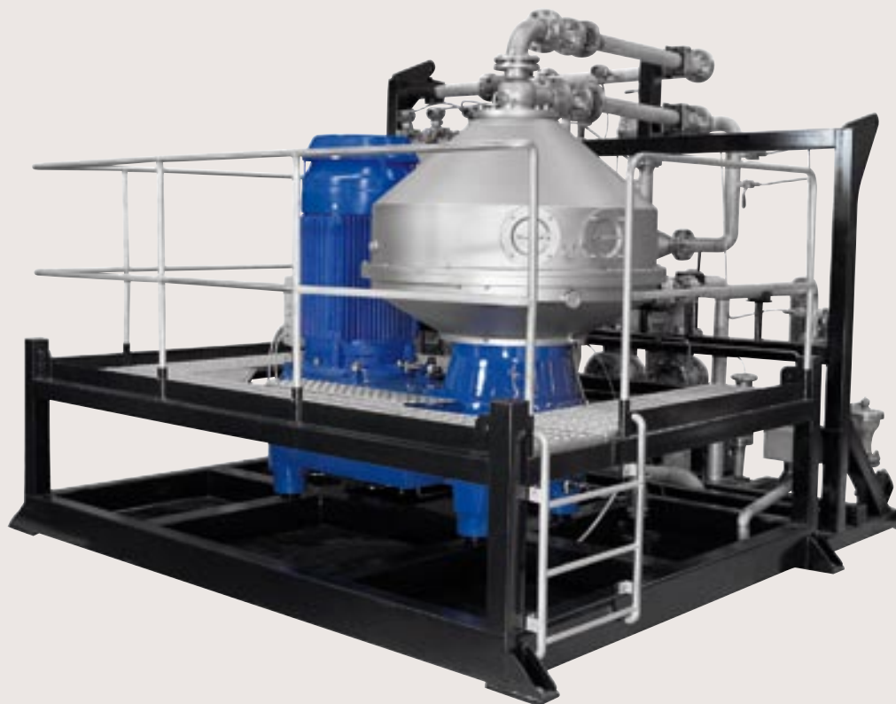
Сепаратор X20 в комплекте с несущей рамой.
