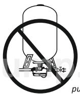
**Внимание!** При использовании в системе гидроаккумулятора вертикального типа, не допускается установка блока ТУРБИПРЕСС непосредственно на фланец гидроаккумулятора (см. рис. 5).
