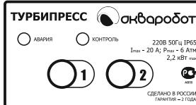
На лицевой поверхности корпуса находятся две кнопки управления ① и ②, а также два светодиода индикации режимов работы – красный (АВАРИЯ) и зеленый (КОНТРОЛЬ).
