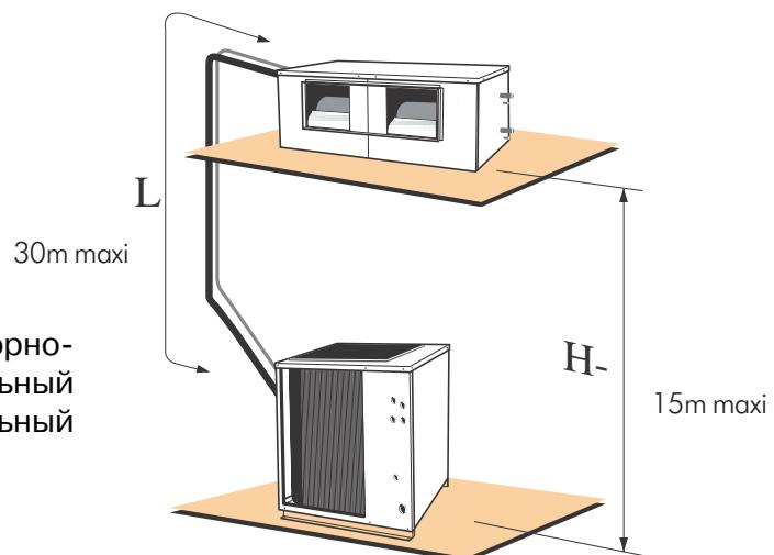
По направлению к компрессорно-конденсаторному блоку соединительный трубопровод должен иметь минимальный уклон 1/250.
