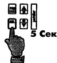
Индикации заданных значений для режима охлаждения и нагрева и основных параметров регулирования (называемых прямыми параметрами) осуществляется нажатием кнопки SEL не менее чем на 5 секунд.
