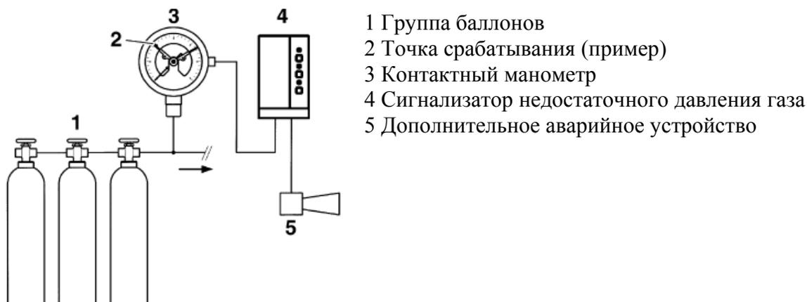
Рис. 3: Контроль над состоянием давления в группе баллонов
