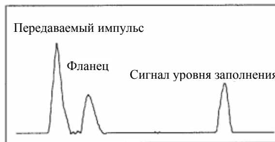
Рис. 4: Жесткий или гибкий зонд с коэффициентом усиления 2
