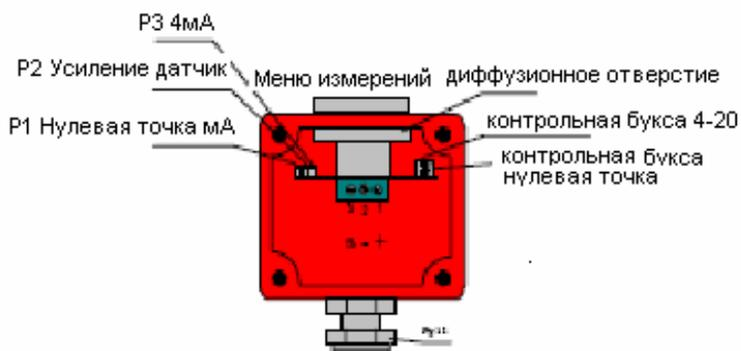
Снимите крышку и установите вольтметр на контрольную буску 4-20 мА.
