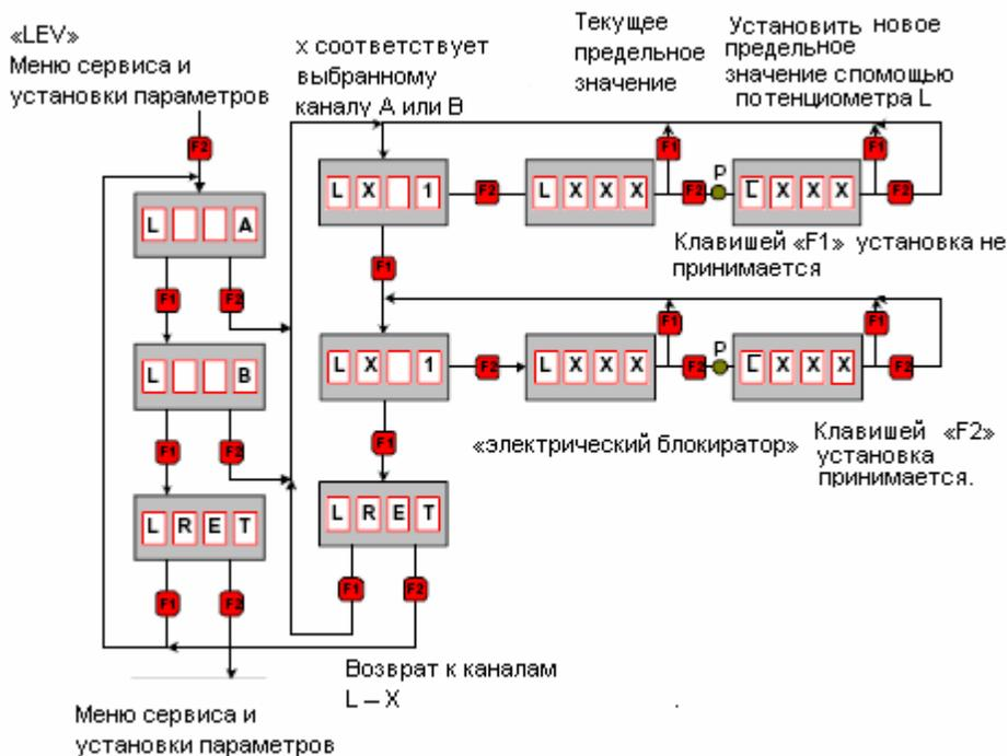
Так как настройка может быть изменена только через потенциометр L, то пользователь посредством штриха над первым знаком индикации сигнализируется. Новую настройку пользователь может подтвердить только путем продолжительного нажатия на клавишу «F2», или отменить нажатием клавиши «F1». После этого пользователь возвращается в меню выбора уровня.
