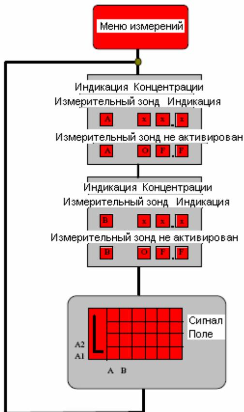
На измерительные зонды постоянно посылается запрос и появляется индикация на дисплее с обозначением точек измерения и текущих измеренных значений.
