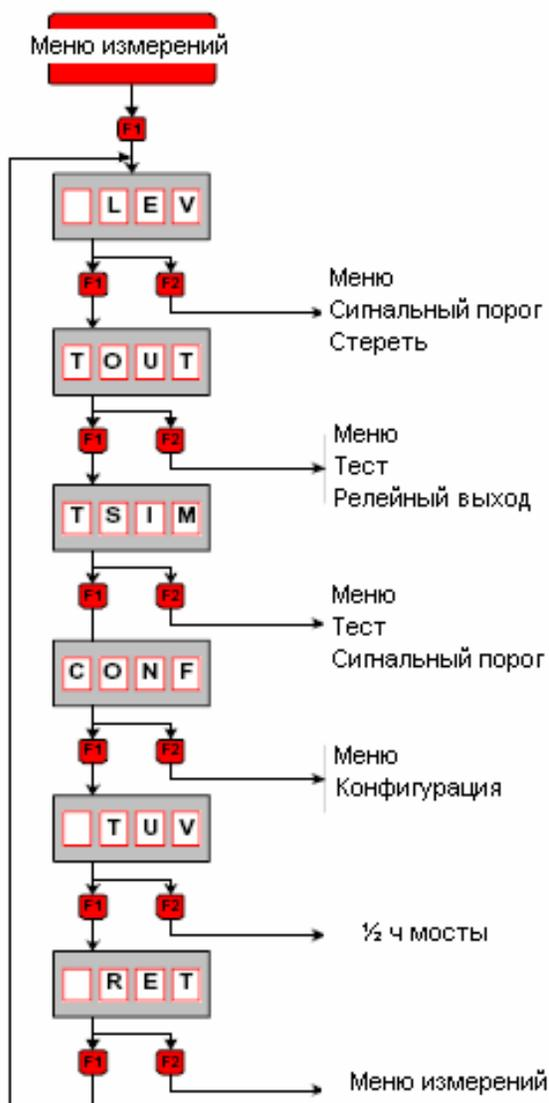
TOUT : Позволяет пользователю с целью проверки установить реле в определенное состояние
