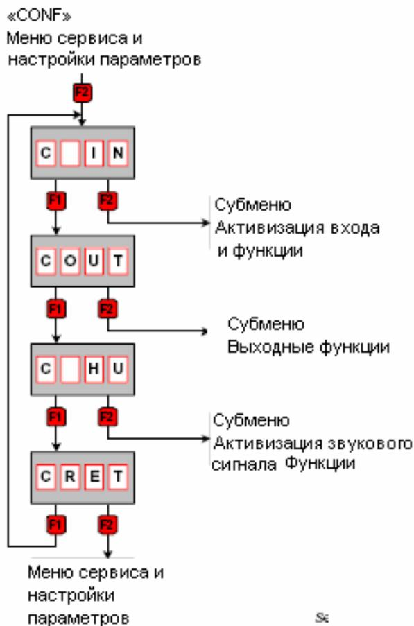
«C IN»: Установите входную функцию каналов аварийных сигналов.
