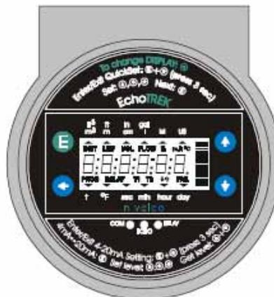
**Основная регулировка аналогового выхода, Индикации и столбиковой диаграммы – это «LEVEL».** Она может быть изменена только в режиме комплексного программирования («Full Parameter Access») смотрите раздел 6.1 (P01).
