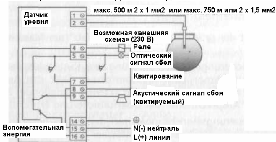
Рисунок 4а Схема подключения для NB 220 H
