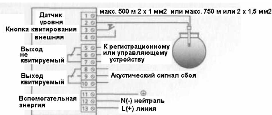
Рисунок 4а Схема подключения для NB 220 QSF
