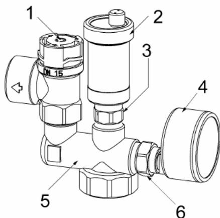
1. Предохранительный клапан, 3 бар , G1/2
