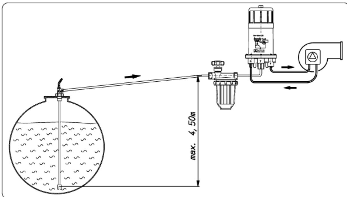
Установка прибора Flow-Control ниже уровня цистерны. Для предотвращения утечки топлива при неисправном всасывающем трубопроводе и более высоком уровне топлива в цистерне следует предусмотреть использование мембранного антисифонного вентиля.
